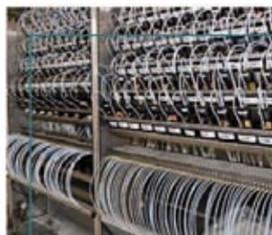
Automatische, computergesteuerte Dosieranlage mit insgesamt 300 verschiedenen Düften
